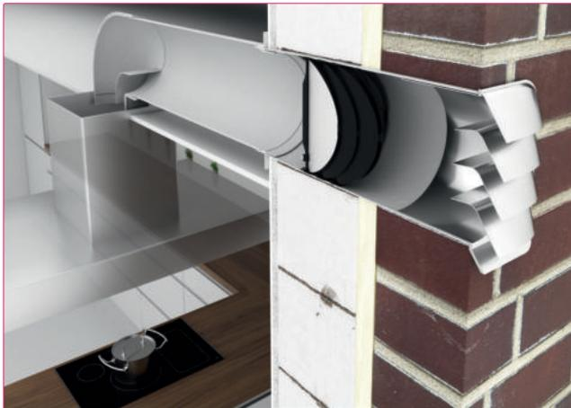
**Intelligente Küchenabluftlösungen spielen heute eine Schlüsselrolle bei der Verbesserung des Raumklimas.** Geruchs- und Fettpartikel, aber auch Feuchtigkeit müssen über einen Luftkanal an die Außenluft abgeführt werden. Gleichzeitig muss die Gebäudehülle, insbesondere die für ein Abluftsystem geschaffene Kernlochbohrung, energetisch abgedichtet werden.
