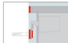
Schiene mit Gummiunterlagen und Gummitüllen befestigen, Schrankdeckel oder Seitenwände mit Gummiband entkoppeln.
