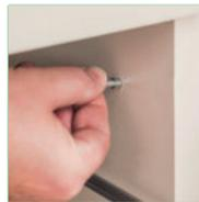
5. Deckelaufnahmestifte an Korpusseite einbohren und einstecken.
