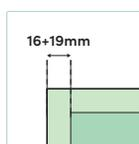
für 16 und 19 mm Seitenwände geeignet
