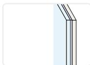
**3,5 mm:** Auf der Aluminiumverbundplatte befindet sich die Motivfolie, darauf ein transparentes UV-Schutzlaminat (abwischbar).
