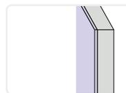
**3,5 mm:** Hinter dem kratzfest beschichteten Acrylglas befinden sich die Motivfolie, ein Schutzlaminat und eine dünne Hartschaumplatte (schwer entflammbar).
