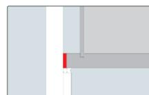
Schranksboden oder Seitenwände mit Gummiband entkoppeln.
