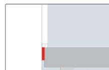
Arbeitsplatte stirnseitig mit PE-Kantenband oder PE-Band von Wand entkoppeln.
