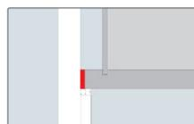
Schranksboden oder Seitenwände mit Gummiband entkoppeln.
