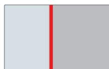
Blenden stirnseitig mit PE-Band von Wand entkoppeln.
