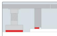
Füße mit Gummirondellen und Blende mit Gummiband von Boden entkoppeln.
