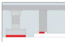
Découpler les pieds avec des rondelles en caoutchouc et découper le bandeau du sol avec la bande en caoutchouc.
