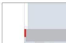
Découpler le plan de travail du mur côté frontal avec la bande à rebord en PE ou la bande en PE.
